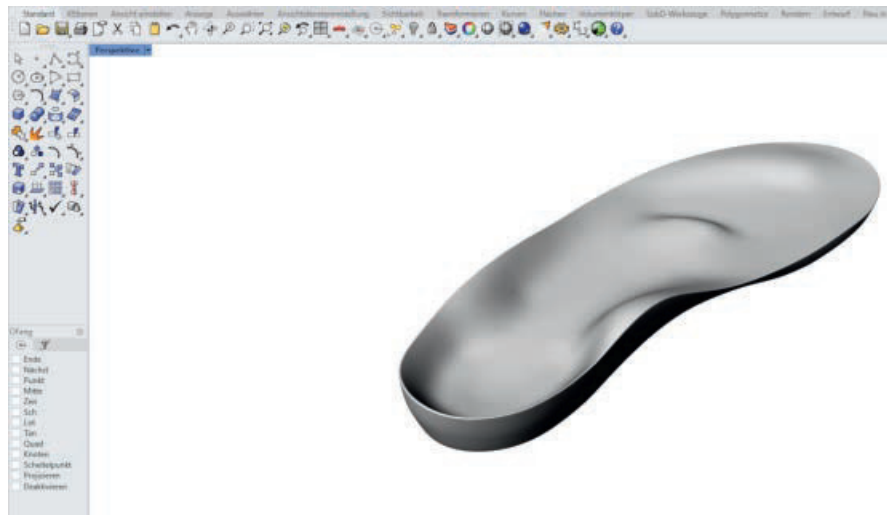
5 Darstellung einer fertig konstruierten Einlage auf der Basis des Vorschlags der KI zur Platzierung der Einlagenelemente.
